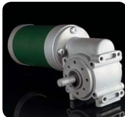
Rotek-Motoren mit Schneckengetriebe kommen dort zum Einsatz, wo aus Platzgründen eine Kraftumlenkung um 90 Grad oder ein zweites Wellenende benötigt werden.
