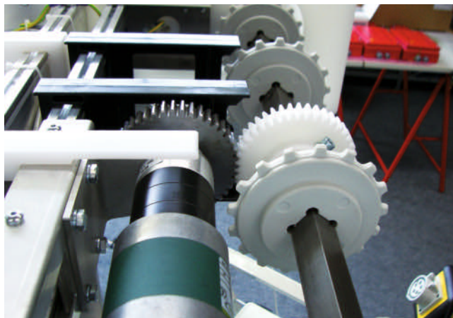
Nutzt man wie hier den Energiesparmotor zum Antrieb eines Gliedergurt-Förderbandes, ist eine besonders kompakte Bauform des Förderbandes möglich
